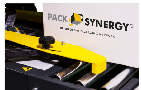
Perfekte Einstellungsmöglichkeiten über Seitenführungen, obere Leerlaufrollen und zusätzlich 4 obere und untere Transportbänder
