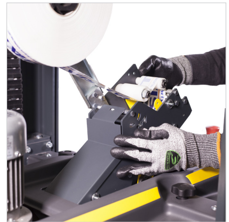
Der schnell abnehmbare Verlebekopf spart Zeit
